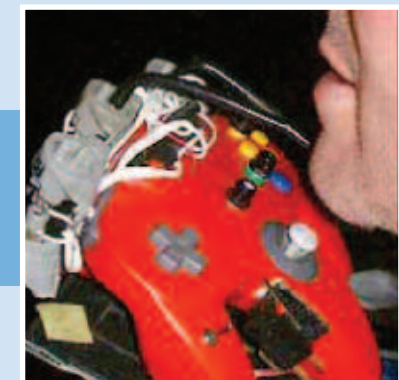
Mando adaptado para Nintendo 64 de Mark Bosanquet Bryant (UK) con botones para soplar y aspirar
